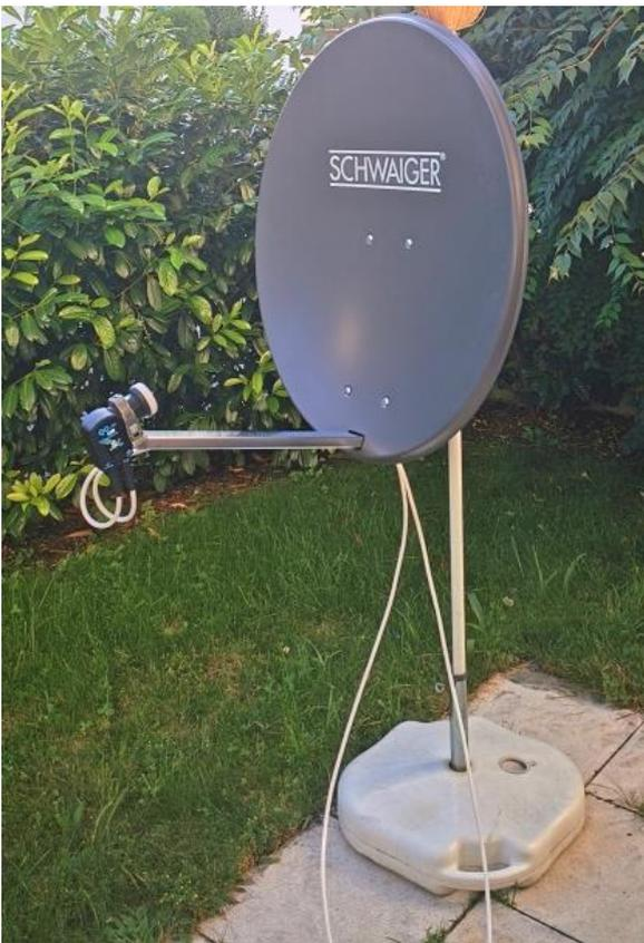
Hier ein Testaufbau mit einem DXPatrol LNB zu sehen. Zu Beginn des Projekts kamen DXPatrol Komponenten zum Einsatz. Der Einstieg für Empfang ist etwas preiswerter als mit den Kuhne Komponenten, kann aber kein DATV-Empfang.
